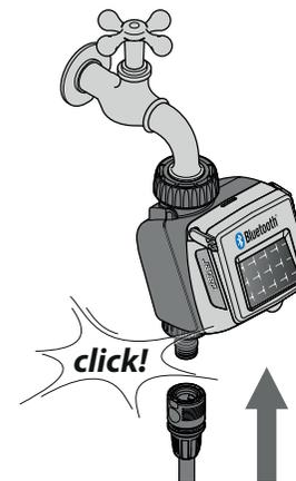
Schließen Sie den Bewässerungskreis mit einer Quick-Click-System-Kupplung oder einer 3/4"-Gewindekupplung an den Anschluss des Bewässerungscomputers an.
